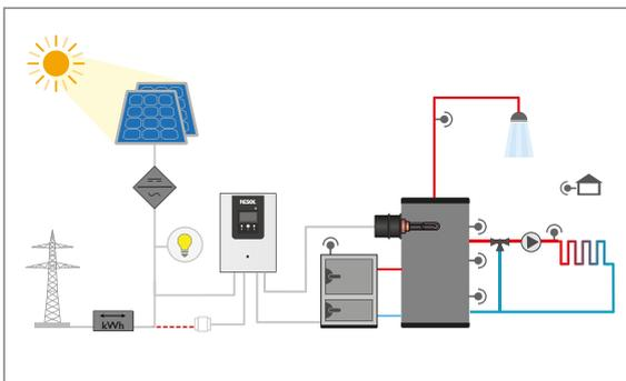
Control de una resistencia eléctrica de calentamiento y de una caldera de biomasa, regulación de un circuito de calefacción mixto\* y producción de ACS\* (mediante módulo de extensión)
