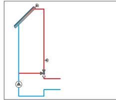
Bypass mediante válvula
