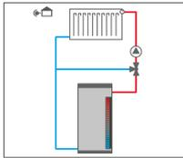
1 circuito de calefacción mezclado con calentamiento auxiliar
