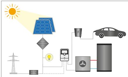
Control de bomba de calor y punto de recarga
