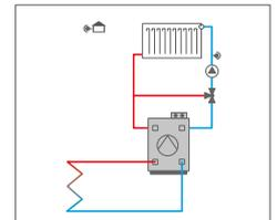
Enfriamiento del circuito de calefacción (p. ej. con bomba de calor)
