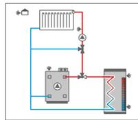
1 circuito de calefacción mezclado con producción de ACS (válvula de inversión)
