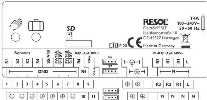
S6: entrada para Grundfos Direct Sensor™, S7: entrada de frecuencia
