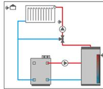
1 circuito de calefacción mezclado con calentamiento auxiliar (demanda y bomba de carga de caldera)
