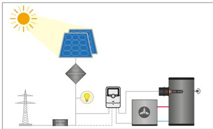
Control resistencia eléctrica de apoyo\*
