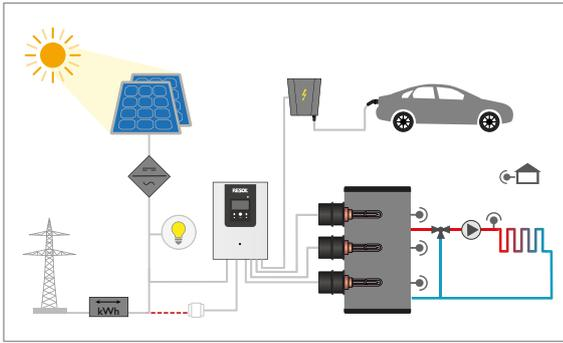
Control de 3 resistencias eléctricas de calentamiento y activación de una wallbox, regulación de un circuito de calefacción mixto\* (mediante módulo de extensión)
