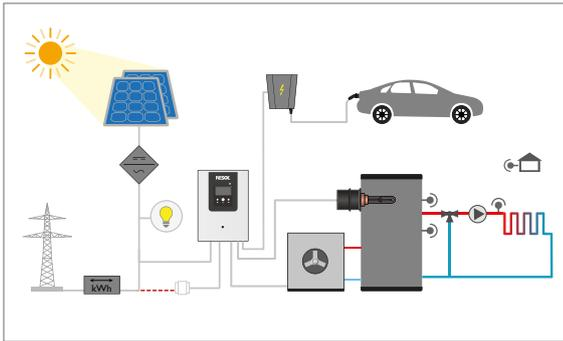
Control de una resistencia eléctrica de calentamiento, activación de una bomba de calor y de una wallbox, regulación de un circuito de calefacción mixto\* (mediante módulo de extensión)
