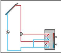
Sistema de energía solar con 1 acumulador estratificado
