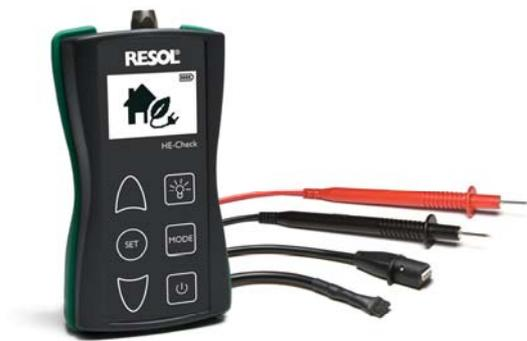
L'HE-Check subentra dove gli strumenti tradizionali non riescono – per esempio se un guasto è causato da un guasto alla pompa o al segnale di controllo. Con la HE-Check, la funzionalità della pompa e dei segnali del controllore possono essere controllati in modo rapido e semplice. Il dispositivo misura e genera segnali di controllo della pompa (0-10 V e segnali PWM) in una gamma di frequenza da 290 fino a 2000 Hz.
