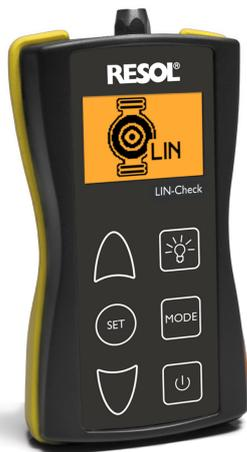
Der LIN-Check erweitert unser umfangreiches Angebot an Werkzeugen für den Fachhandwerker. Er bietet die Möglichkeit, LIN-Bus-Pumpen einer Funktionsprüfung und Fehlerdiagnose zu unterziehen.
