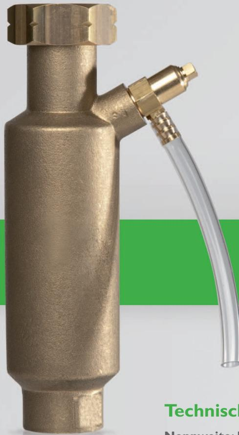
Damit eine Solaranlage immer effizient arbeiten kann, muss sie regelmäßig entlüftet werden. Der RESOL Lufttopf LT20 sorgt im solaren Vorlaufstrang für eine permanente Luftabscheidung aus dem Wärmeträgermedium. Mit dem Entlüftungsventil und dem beiliegenden Schlauch kann die abgeschiedene Luft manuell abgelassen werden.
