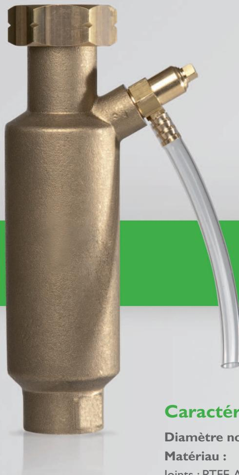
Pour garantir l'efficacité d'une installation de chauffage solaire thermique, il est nécessaire de purger celle-ci régulièrement. Le purgeur d'air RESOL sert à purger le circuit de départ. L'air émanant du fluide caloporteur s'accumule dans la partie supérieure du purgeur d'air et peut être évacué manuellement si nécessaire au niveau de la vanne de purge d'air.
