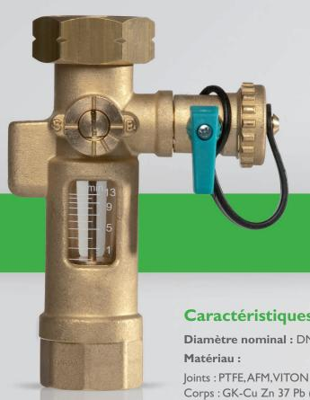
Pour le bon fonctionnement d'une installation de chauffage solaire thermique, il est nécessaire de bien régler le débit. Le débitmètre VM1020 RESOL sert à afficher des débits de 1 à 13 litres/minute, le limiteur de débit intégré s'utilise pour limiter ceux-ci. La vanne de vidange et de remplissage permet d'effectuer des opérations de rinçage et de vidange. De plus, le débitmètre est doté d'une ouverture pour y appliquer une sonde plongeante permettant de mesurer la température du retour.
