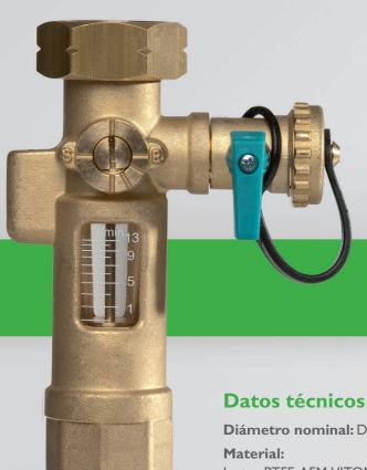
Para funcionar correctamente, los sistemas de energía solar deben tener un caudal adecuado. El caudalímetro VM1020 de RESOL ha sido diseñado para indicar de forma fiable el caudal ajustado en esos sistemas entre 1 y 13 l/min. Integra un limitador de caudal para reducirlo y una válvula de llenado/vaciado para realizar operaciones de llenado y vaciado. También integra una apertura para una sonda de inmersión para medir la temperatura del retorno.
