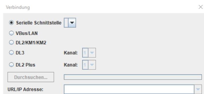
Wenn ein Schnittstellenadapter VBus®/USB verwendet wird, **Serielle Schnittstelle** anwählen und den COM-Port einstellen. Im Zweifelsfall den COM-Port in der Systemsteuerung nachsehen.
