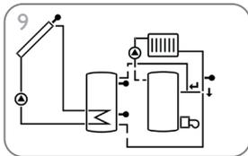
Sistema de energía solar con aumento de la temperatura de retorno del circuito de calefacción (página 42)
