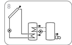
Sistema de energía solar con calentamiento auxiliar por caldera de biomasa (página 36)
