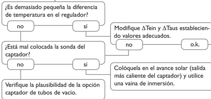
La diferencia de temperatura entre el acumulador y el captador aumenta mucho cuando el sistema está activo; el circuito del captador no puede evacuar el calor.
