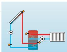
La función termostato actúa independientemente del funcionamiento solar y se puede utilizar, por ejemplo, para aprovechar el exceso de calor o para activar el calentamiento auxiliar.
