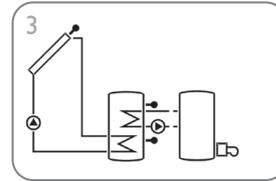
Sistema de energía solar con calentamiento auxiliar (página 19)
