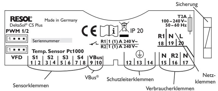
Die Versorgungsspannung muss 100–240 V~ (50–60 Hz) betragen. Flexible Leitungen müssen mit den beiliegenden Zugentlastungen und den zugehörigen Schrauben am Gehäuse fixiert werden.
