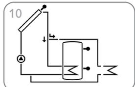
Standard-Solaranlage mit Überwärmefuhr (Seite 45)
