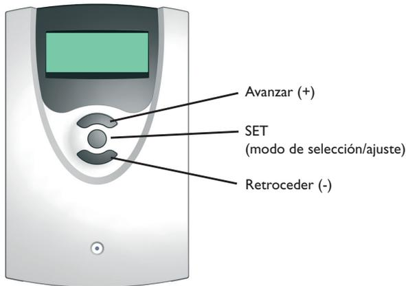
El regulador se maneja con las 3 teclas situadas debajo de la pantalla. La tecla superior (+) sirve para avanzar en el menú o para aumentar valores. La tecla inferior (-) sirve para retroceder en el menú o para disminuir valores. La tecla del medio se usa para seleccionar canales y confirmar ajustes.
