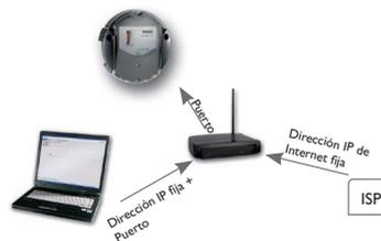
Presentación esquemática: acceso remoto al DL2, router con dirección IP de Internet fija.
