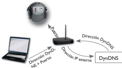
Presentación esquemática: acceso remoto al DL2, router con dirección DynDNS.
