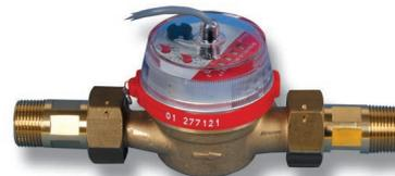
El caudalímetro RESOL V40 se usa para medir el caudal del agua en el circuito solar del sistema. Cuando monte dicho caudalímetro en el sistema, tenga en cuenta el sentido del flujo indicado en el caudalímetro. Para estabilizar el régimen del flujo en la tubería, deje un espacio de entrada y salida de 30 cm como mínimo en cada lado del caudalímetro.
