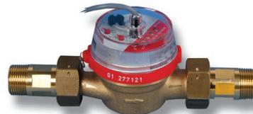
Pour la détermination du débit volumique dans le circuit on utilise un débitmètre RESOL V40. L'unité de mesurage doit être montée en tenant compte de la direction du courant du liquide. Pour obtenir un débit plus homogène on doit prévoir une conduite d'entrée de 30 cm et une conduite de sortie de 30 cm.
