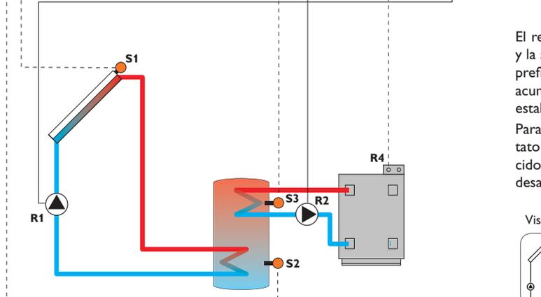
El regulador compara la diferencia de temperatura entre la sonda de captador S1 y la sonda de acumulador S2. En cuanto la diferencia sea mayor o igual que el valor prefijado para la activación de la bomba (R1), ésta entrará en funcionamiento y el acumulador se cargará hasta alcanzar el valor de desactivación o el valor máximo establecido.
