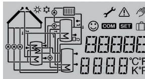
La pantalla System Monitoring consta de 3 partes: el indicador de parámetros, la barra de símbolos y el esquema de sistema.
