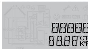
El indicador de parámetros consta de dos líneas. La línea superior de 16 segmentos indica principalmente los nombres de los parámetros y los submenús. La línea inferior de 16 segmentos indica valores y parámetros.
