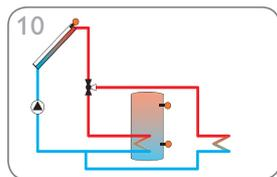
Sistema de energía solar con 1 acumulador y disipación del exceso de calor (página 17)
