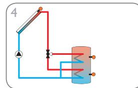
Sistema de energía solar con 1 acumulador y 1 válvula de 3 vías para la carga estratificada (página 11)
