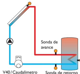
Ejemplo de posición de las sondas de avance y retorno si se realiza un balance térmico.
