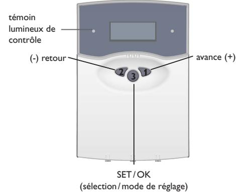
Le régulateur se manie avec les 3 touches de réglage situées sous l'écran d'affichage. La touche „avance“ (1) sert à avancer dans le menu d'affichage ou à augmenter des valeurs de réglage. La touche „retour“ (2) sert à effectuer l'opération inverse. La touche 3 permet de sélectionner des lignes de menu et de valider des opérations.
