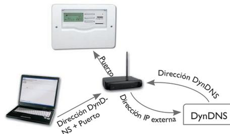
Presentación esquemática: acceso remoto al DL3, router con dirección DynDNS.
