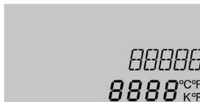
El indicador de canales consta de dos líneas. La línea superior de 16 segmentos indica principalmente los nombres de los parámetros y los submenús. La línea inferior de 7 segmentos indica valores y parámetros.
