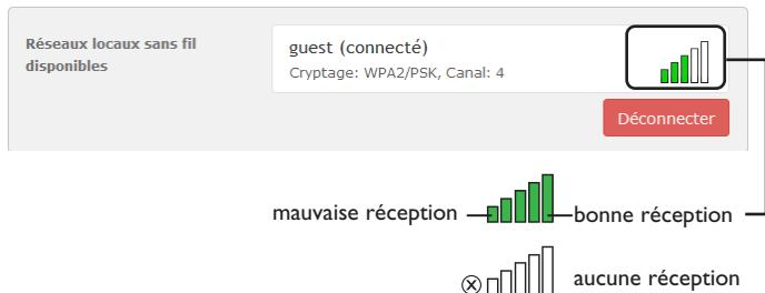
Lorsqu'une connexion à un réseau WLAN a été établie, mais que le WLAN n'est plus accessible, aucun signal s'affiche.
