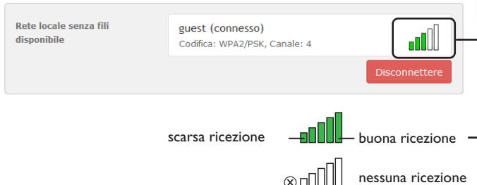
Se è stata creata una connessione a una WLAN, ma questa WLAN non è più disponibile, viene visualizzato "nessuna ricezione".
