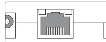
La porta LAN si trova sulla parte frontale del modulo di comunicazione KM2 e supporta velocità di trasferimento fino a 100 Mbit al secondo.
