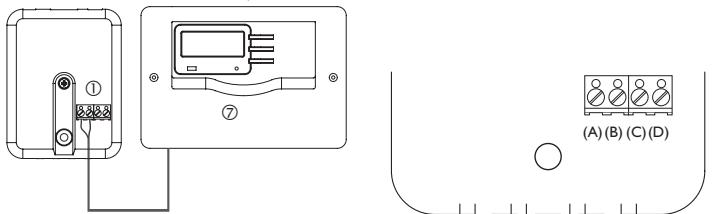
Conecciones de borne del módulo de comunicación
