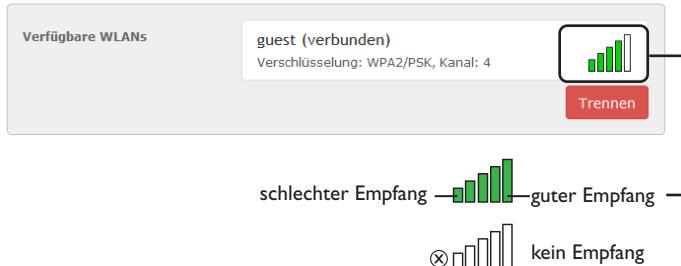
Wenn eine Verbindung zu einem WLAN eingerichtet wurde, das WLAN aber nicht mehr erreichbar ist, wird kein Empfang angezeigt.
