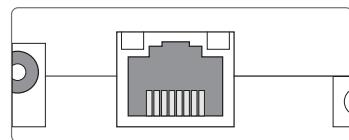
Le connecteur LAN se trouve sur l'avant du boîtier de l'appareil; il supporte des débits de transfert de jusqu'à 100 MBit par seconde.
