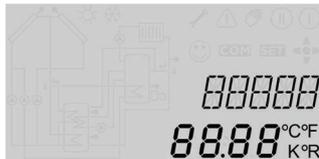
Die Kanalanzeige besteht aus zwei Zeilen. In der oberen 16-Segment-Anzeige werden hauptsächlich Kanalnamen/Menüpunkte eingblendet. In der unteren 7-Segment-Anzeige werden Kanalwerte und Einstellparameter angezeigt.
