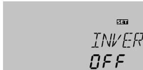
El relé seleccionado se conecta durante una carga solar (R1 y/o R2) o al activarse una función solar especial. El relé paralelo también se puede conectar con los contactos invertidos (**INVER**).
