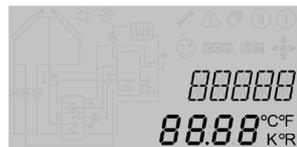
La visualización de parámetros consta de dos líneas. En la línea superior de 16 segmentos se visualizan principalmente los nombres de parámetro/elementos de menú. En la línea inferior de 7 segmentos se visualizan los valores de parámetro y parámetros de ajuste.
