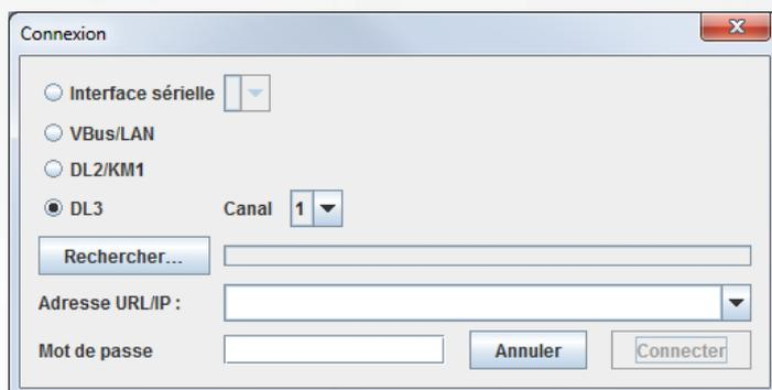
Lorsque vous utilisez un DL3, sélectionnez le canal correspondant au régulateur auquel vous souhaitez vous connecter. Le canal 1 est l'entrée VBus<sup>®</sup> 1 sur le DL3, le canal 2 est l'entrée VBus<sup>®</sup> 2, etc.
