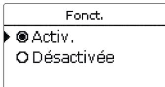
L'option **Fonction** permet de désactiver ou de réactiver provisoirement les fonctions optionnelles préalablement enregistrées. Dans ce cas, les réglages correspondants seront sauvegardés et les relais leur ayant été attribués ne pourront pas être attribués à d'autres fonctions.
