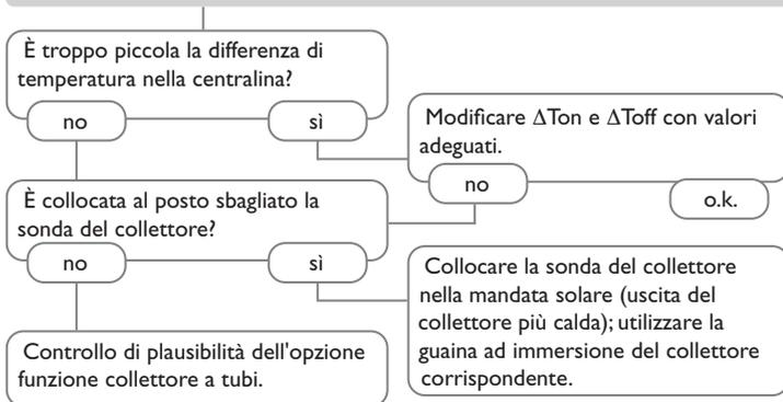
La differenza di temperatura tra il serbatoio e il collettore aumenta molto durante il funzionamento; il circuito del collettore non può asportare il calore.
