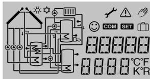
Il display di monitoraggio del sistema è suddiviso in 3 settori: l'indicatore di canali, la barra dei simboli e lo schema di sistema.
