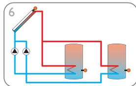
sistema con 2 serbatoi e comando pompa (p. 15)
