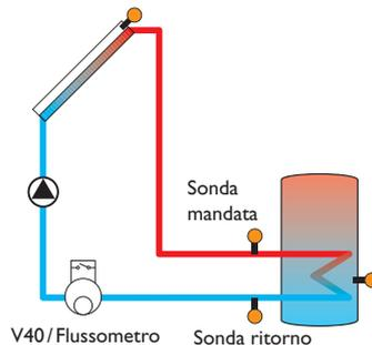
Esempio di posizionamento delle sonde mandata e ritorno se vengono realizzati bilanci termici.
