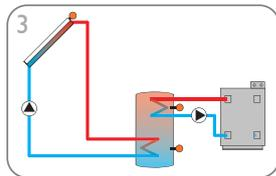
sistema con 1 serbatoio e scambio termico (p. 12)
