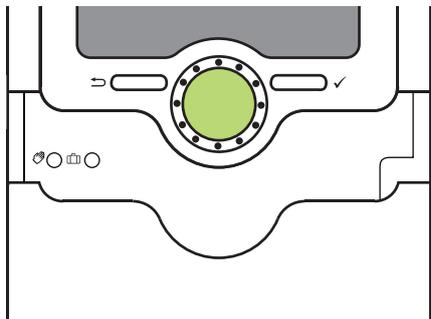
La centralina viene comandata mediante 2 tasti e 1 interruttore rotativo (Lightwheel®) disposti sotto il display:
