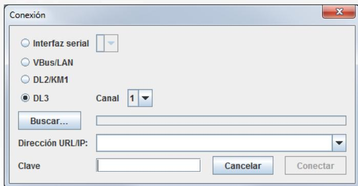
Si utiliza un DL3, seleccione el canal correcto para el regulador al que desee acceder. Canal 1 es la entrada 1 de VBus® en el DL3, canal 2 es la entrada 2 de VBus® y así sucesivamente.
