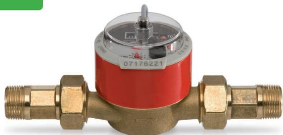
Il V40 RESOL è uno strumento di misura munito di un contatore per rilevare la portata dell'acqua o delle soluzioni giolate. Viene impiegato in abbinamento ai calorimetri RESOL. Allo scorrimento di un determinato volume di liquido, il V40 emette un impulso.
