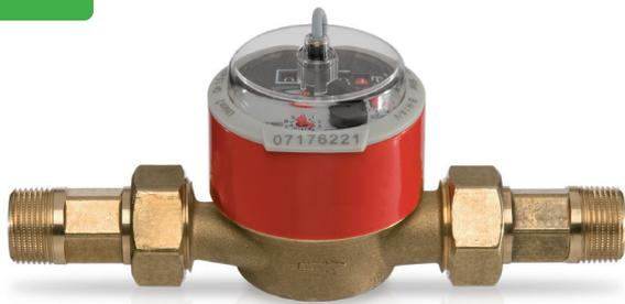
Das RESOL V40 ist ein Messgerät mit Kontaktgeber zur Erfassung des Durchflusses von Wasser oder Wasser-Glykol-Gemischen und wird in Verbindung mit RESOL-Wärmemengenzählern eingesetzt. Nach dem Durchströmen eines konkreten Volumens gibt das V40 einen Impuls an den Wärmemengenzähler ab.
