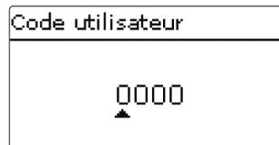
Le menu **Code utilisateur** permet de saisir un code utilisateur. Chaque chiffre du code à 4 chiffres doit être saisi et confirmé un par un. Après avoir validé le dernier chiffre du code, le régulateur passera au niveau de menu supérieur.
