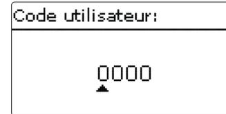
Le menu **Code utilisateur** permet de saisir un code utilisateur. Chaque chiffre du code à 4 chiffres doit être saisi et confirmé un par un. Après avoir validé le dernier chiffre du code, le régulateur passera au niveau de menu supérieur.
