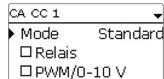
Si vous sélectionnez **Demande**, vous devrez d'abord activer et régler une demande dans le menu **Chauffage / Relais com.**. Si vous sélectionnez **Paramètres**, le menu **Chauffage / Relais com. / Demande** s'affichera.
