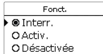
L'option **Fonct.** permet de désactiver ou de réactiver provisoirement les fonctions optionnelles préalablement enregistrées. Dans ce cas, les réglages correspondants seront sauvegardés et les sorties leur ayant été attribuées ne pourront pas être attribuées à d'autres fonctions. Les sondes correspondantes seront surveillées pour détecter des erreurs.
