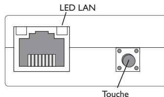
La touche permet d'effectuer un reset pour remettre la configuration de l'appareil aux réglages d'usine.
