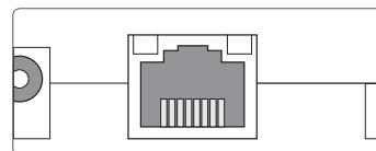
Die LAN-Buchse befindet sich an der Vorderseite des Gerätes und unterstützt Transferraten von bis zu 100 MBit pro Sekunde.
