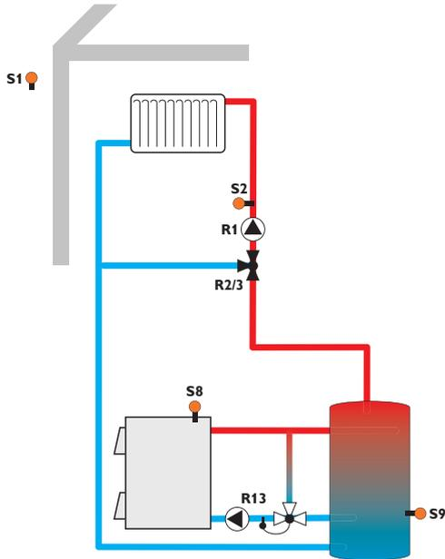
Mit dem Vorlaufsensor S2 und dem Außensensor S1 wird ein gemischter Heizkreis witterungsgeführt geregelt. Der Festbrennstoffkessel wird abhängig von der Temperaturdifferenz zwischen den Sensoren S8 (Festbrennstoffkessel) und S9 (Speicher) angesteuert.
