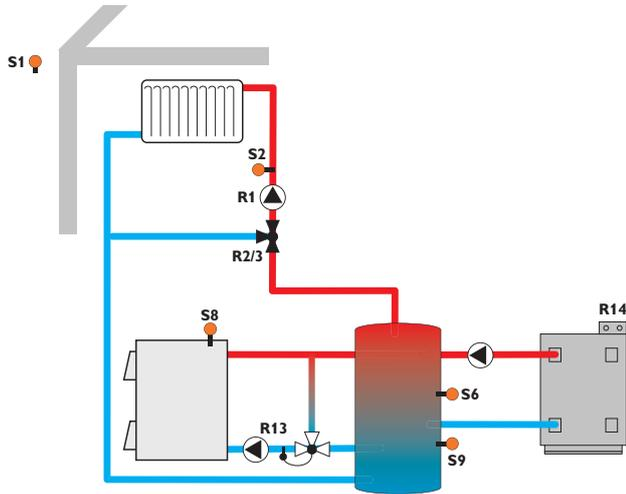
Mit dem Vorlaufsensor S2 und dem Außensensor S1 wird ein gemischter Heizkreis witterungsgeführt geregelt. Die potenzialfreie Kesselanforderung wird abhängig von der Temperaturdifferenz zwischen der Vorlaufsolltemperatur und dem Messwert am Nachheizsensor S6 ausgelöst. Der Festbrennstoffkessel wird abhängig von der Temperaturdifferenz zwischen den Sensoren S8 (Festbrennstoffkessel) und S9 (Speicher) angesteuert.
