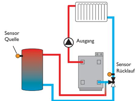
Diese Funktion dient dazu, Wärme aus einer Wärmequelle an den Heizkreisrücklauf zu übertragen.
