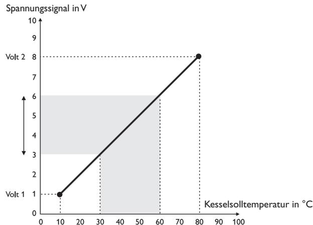
Mit den Einstellkanälen **TMax** und **TMin** können die Maximal- und Minimalwerte für die Kessel Solltemperatur eingestellt werden.
