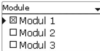
In diesem Untermenü können bis zu 5 externe Module angemeldet werden. Alle angeschlossenen und vom Regler erkannten Module stehen zur Auswahl.
