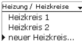
Werden ein oder mehrere externe Erweiterungsmodul angeschlossen, müssen sie im Regler angemeldet werden. Nur angemeldete Module erscheinen bei der Heizkreisauswahl. Wird **neuer Heizkreis...** erstmalig angewählt, wird der erste Heizkreis dem Regler zugewiesen.
