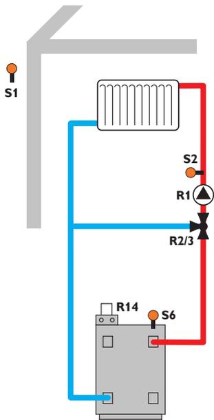
Mit dem Vorlaufsensor S2 und dem Außensensor S1 wird ein gemischter Heizkreis witterungsgeführt geregelt. Die potenzialfreie Kesselanforderung wird abhängig von der Temperaturdifferenz zwischen der Vorlaufsoltemperatur und dem Messwert am Nachheizsensor S6 ausgelöst.
