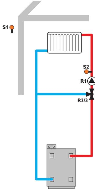
Mit dem Vorlaufsensor S2 und dem Außensensor S1 wird ein gemischter Heizkreis witterungsgeführt geregelt.
