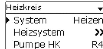
Wenn die gemessene Vorlaufstemperatur von der Vorlaufsolltemperatur abweicht, wird der Mischer angesteuert, um die Vorlaufstemperatur entsprechend anzupassen. Die Mischerlaufzeit kann mit dem Parameter **Intervall** eingestellt werden.
