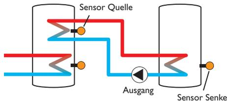
Diese Funktion dient dazu, Wärme von einer Wärmequelle an eine Wärmesenke zu übertragen.
