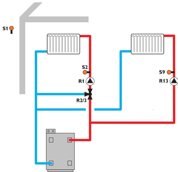
Mit den Vorlaufsensoren S2 bzw. S9 und dem Außensensor S1 werden ein gemischter und ein ungemischter Heizkreis witterungsgeführt geregelt.
