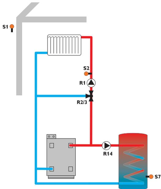
Mit dem Vorlaufsensor S2 und dem Außensensor S1 wird ein gemischter Heizkreis witterungsgeführt geregelt. Die Brauchwassererwärmung wird abhängig vom Messwert am Brauchwasser-Sensor S7 ausgelöst.
