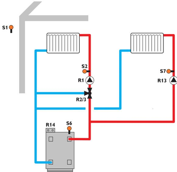
Mit den Vorlaufsensoren S2 bzw. S7 und dem Außensensor S1 werden ein gemischter und ein ungemischter Heizkreis witterungsgeführt geregelt. Die potenzialfreie Kesselanforderung wird abhängig von der Temperaturdifferenz zwischen den Vorlaufsoltemperaturen und dem Messwert am Nachheizsensor S6 ausgelöst.
