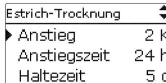
Wird die Vorlaufsolltemperatur nach den ersten 24 Stunden bzw. nach den jeweiligen Anstiegszeiten nicht erreicht oder wird sie dauerhaft überschritten, wird die Estrich-Trocknung abgebrochen. Der Heizkreis wird ausgeschaltet und eine Fehlermeldung angezeigt. Das Tastenkreuz leuchtet rot.
