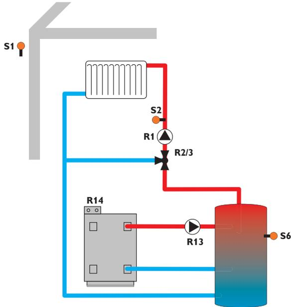
Mit dem Vorlaufsensor S2 und dem Außensensor S1 wird ein gemischter Heizkreis witterungsgeführt geregelt. Die potenzialfreie Kesselanforderung und die Ansteuerung einer Kessel-Ladepumpe werden abhängig von der Temperaturdifferenz zwischen der Vorlauf Solltemperatur und dem Messwert am Nachheizsensor S6 ausgelöst.
