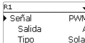
En este menú se puede ajustar el tipo de señal y la velocidad mínima para cada relé del regulador y del módulo externo.
