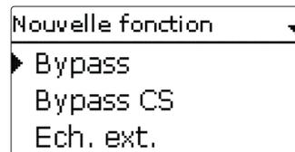
Les menus **Fonct. option.** / **Ajouter nouv. fonc.** permettent de sélectionner et de régler des fonctions optionnelles.
