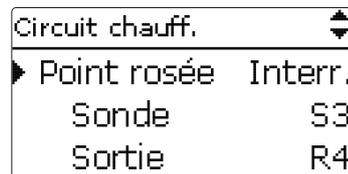
Lorsque **Interr.** est sélectionné, une entrée ainsi qu'une sortie peuvent être attribuées au capteur de point de rosée. Lorsque le capteur de point de rosée détecte une condensation, le refroidissement s'arrête.
