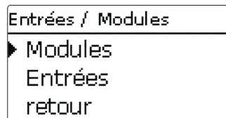
Le menu **Entrées/Modules** permet d'activer et de désactiver les modules externes et de calibrer des sondes.
