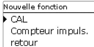
Le menu **CAL** permet d'activer et de régler en tout 7 calorimètres internes et 3 compteurs d'impulsions.
