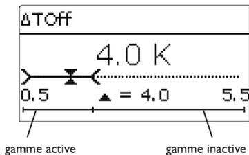
Lorsqu'un paramètre est verrouillé par rapport à un autre, la gamme de réglage correspondante diminue en fonction de la valeur de l'autre paramètre.
