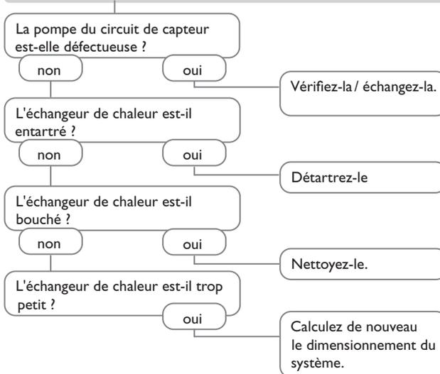
La pompe du circuit solaire ne marche pas alors que le capteur est nettement plus chaud que le réservoir.
