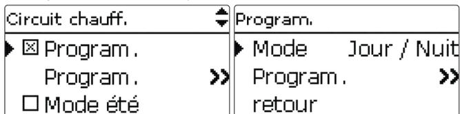
Le paramètre **Mode** offre la possibilité de choisir entre les modes de correction suivants :
