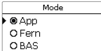
➔ Pour pouvoir utiliser l'application, réglez le **mode** correspondant sur **App**. Si vous utilisez l'application, vous pourrez régler le mode de fonctionnement dans le menu du régulateur ainsi que via l'application.
