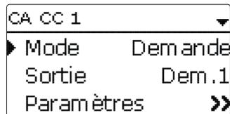
En mode **Jour/Off** (voir page 68) la nuit, le circuit de chauffage et le chauffage d'appoint se désactivent. L'optimisation démarrage permet d'activer le chauffage d'appoint avant le début du fonctionnement de jour pour que le réservoir atteigne une température suffisamment élevée en temps voulu. L'optimisation arrêt permet de désactiver le chauffage d'appoint avant le fonctionnement de nuit.
