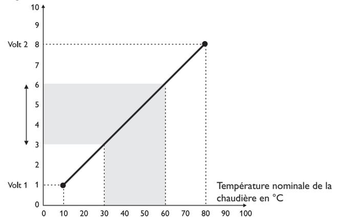
Les paramètres **Tmax** et **Tmin** permettent de définir les valeurs minimales et maximales de la température nominale de la chaudière.
