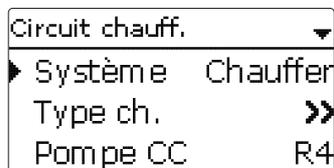
En cas d'écart entre la température du départ et la valeur nominale définie, la vanne mélangeuse se mettra en marche pour réduire cet écart de température.
