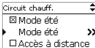
Pendant le mode d'été, le circuit de chauffage est inactif.
