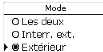
En mode **Extérieur** le refroidissement s'active, lorsque la température extérieure de refroidissement est dépassée.
