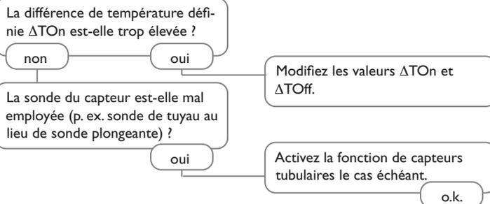
La différence de température entre le réservoir et le capteur augmente beaucoup lorsque le système est activé; le circuit du capteur n'arrive pas à évacuer la chaleur.
