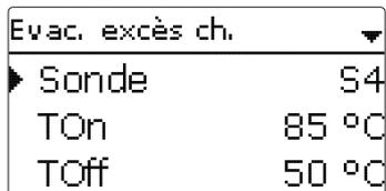
Cette option sert à dissiper l'excès de chaleur vers le circuit de chauffage afin d'éviter une surchauffe du système. Lorsque la température mesurée par la sonde sélectionnée est supérieure à la température d'activation, la température nominale du départ est réglée à la valeur définie. L'évacuation de l'excès de chaleur se désactive lorsque la température est inférieure à la température de désactivation.
