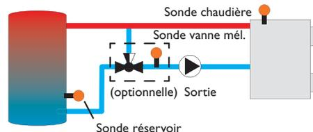
Cette fonction permet de transférer la chaleur d'une chaudière à combustible solide à un réservoir.
