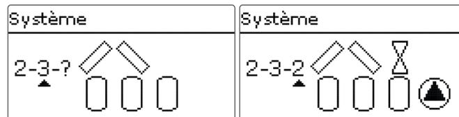
Le régulateur peut s'utiliser pour les systèmes dotés au plus de 3 champs de capteurs et de 4 réservoirs solaires (ou de maximum 3 ou 2 réservoirs solaires si le système a 2 ou 3 champs de capteurs).
