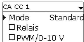
Si vous sélectionnez **Demande**, vous devrez d'abord activer et régler une demande dans le menu **Chauffage / Relais com.**. Si vous sélectionnez **Paramètres**, le menu **Chauffage / Relais com. / Demande** s'affichera.
