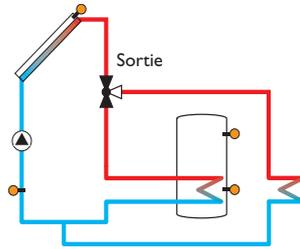
Cette fonction sert à dissiper l'excès de chaleur vers un échangeur thermique externe (p. ex. fan coil) afin d'éviter une surchauffe des capteurs lors de journées très ensoleillées.
