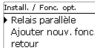
Ce menu permet d'effectuer tous les réglages relatifs à la partie non solaire de l'installation. Vous pouvez à présent sélectionner et régler jusqu'à 16 fonctions optionnelles.
