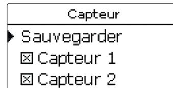
Lorsqu'il est possible de sélectionner plusieurs options en même temps, celles-ci s'affichent précédées d'une case. Après avoir sélectionné l'option voulue, la case correspondante apparaît cochée (x).
