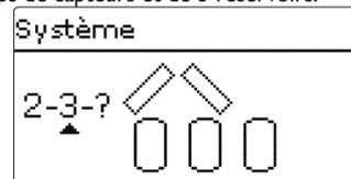
La variante hydraulique correspond aux différents actionneurs pouvant être contrôlés. Ceux-ci s'affichent sur l'écran lors du choix de la variante. Le symbole supérieur indique l'actionneur des champs de capteurs, le symbole inférieur celui des réservoirs.
