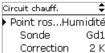
Lorsque **Humidité** est sélectionnée, le régulateur calcule le point de rosée à l'aide de la sonde d'humidité sélectionnable.
