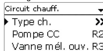
Le sous-menu **Type ch.** permet de choisir et de régler le mode de commande des circuits de chauffage. 5 modes sont disponibles :
