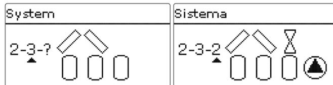
El regulador soporta hasta 3 campos de captación y hasta 4 acumuladores solares (con 2 o 3 campos de captación ,solo hasta 3 o 2 acumuladores solares).
