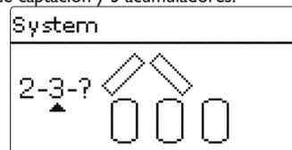
La variante hidráulica corresponde al tipo de cargas que deben ser controladas. Se visualiza en la pantalla mediante los símbolos de carga. El símbolo superior corresponde a las cargas de los campos de captación, el símbolo inferior a las de los acumuladores.
