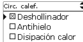
La función deshollinador está activada por defecto en todos los circuitos de calefacción. Para activar el modo de deshollinador, pulse el botón (6) durante 5 segundos.
