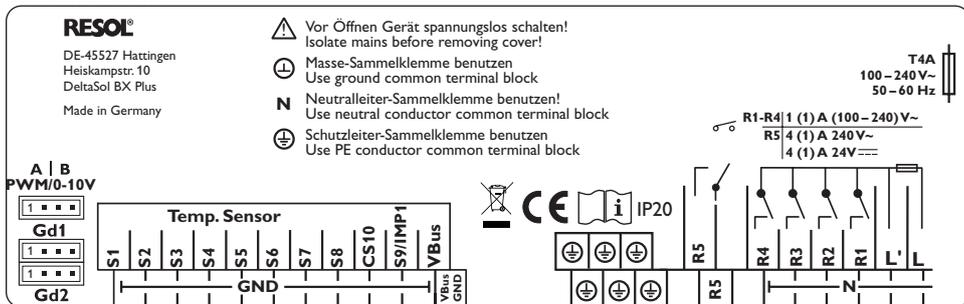
El caudalímetro **V40** puede ser conectado a los terminales S9/IMP1 y GND sin importar la polaridad.
