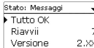
Nel menu **Stato/Messaggi** vengono visualizzati i messaggi di avvertenza e di errore. Durante il funzionamento normale, il display visualizza **Tutto OK**.
