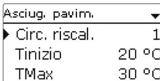
La centralina passa al menu di stato dell'asciugatura pavimento. Nel display viene visualizzata la **Fase** corrente e il **Tempo residuo** viene conteggiato a ritroso (dd:hh). I tasti disposti a croce lampeggiano in verde.
