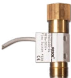
El flujostato FS07/FS08 sirve para detectar caudales; dispone de un conmutador magnético de lengüeta que se cierra cada vez que el flujostato detecta un caudal superior a 1 litro por minuto.
