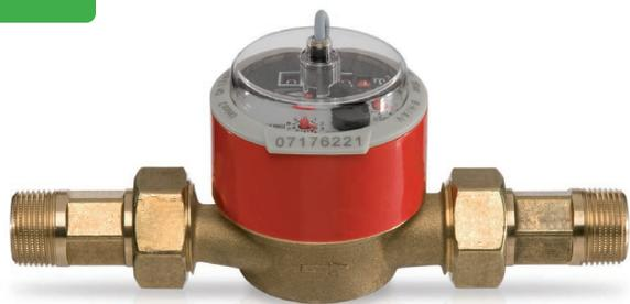
El V40 de RESOL es un instrumento de medición equipado con un emisor de impulsos para medir el caudal del agua o de las mezclas de agua y glicol; se utiliza en combinación con contadores de energía de RESOL. Después de circular un determinado volumen de líquido, el V40 le envía un impulso al contador de energía.
