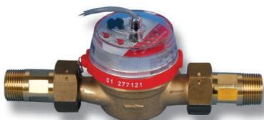
Il RESOL V40 è un apparecchio di misurazione con contattore per il rilevamento della portata di acqua o miscela acqua-glicole, che viene utilizzato in abbinamento con il contattore DeltaSol® M integrato. Dopo il passaggio di un determinato volume il V40 manda un impulso al calorimetro. Da tali impulsi e dalla differenza di temperatura misurata il calorimetro calcola, sulla base di parametri definiti (tipo di glicole, densità, capacità termica, ecc.), la quantità di calore utilizzata.
