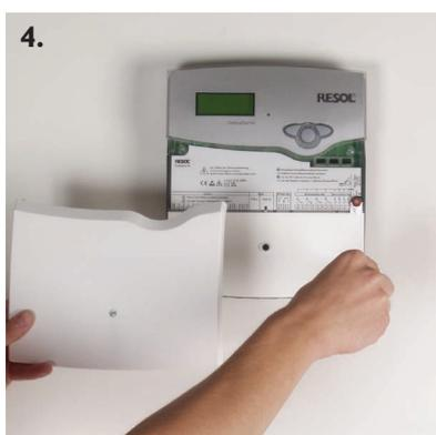
Il montaggio può essere eseguito esclusivamente in locali interni asciutti su una base di appoggio piana. Tenere presente che, per un corretto funzionamento sul luogo prescelto, l'apparecchio non deve essere esposto a campi elettromagnetici forti.
