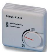
Il regolatore a distanza RTA11-M consente una comoda regolazione della curva di riscaldamento della centralina nel locale di soggiorno. L'innalzamento della curva di riscaldamento produce l'aumento della temperatura di mandata, mentre l'abbassamento della curva ne produce la diminuzione. Il regolatore a distanza contiene inoltre le funzioni "Circuito di riscaldamento spento" e "Riscaldamento rapido".
