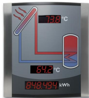
Le grand panneau d'affichage GA3 RESOL est conçu pour être branché sur un régulateur RESOL à travers le RESOL VBus®. Il sert à visualiser les données du régulateur: les températures des panneaux solaires et du réservoir, la quantité de chaleur produite par le système.
