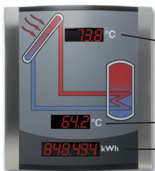
**Note:** Lorsqu'il n'y a pas d'affichages sur les écrans, vérifier les connexions sur les bornes VBus®.
