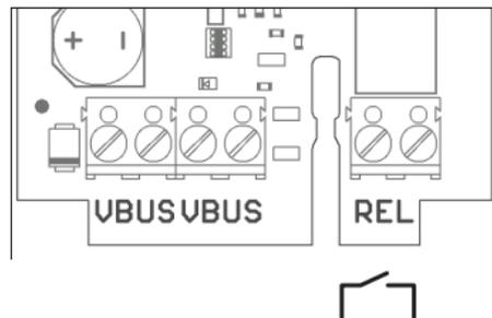
Anschlussklemmen des AM1 / terminals of the AM1 / bornes du module avertisseur AM1 / morsetti di collegamento dell'AM1 / morsetti di collegamento dell'AM1
