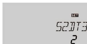
Ces fonctions fonctionnent indépendamment de la fonction  $\Delta T$ , avec un seuil maximal / minimal propre. Le canal **DT3** contient les paramètres **DT30 / DT3F** (différence de température d'activation et de désactivation), **DT3N** (différence de température nominale) et **AUG3** (augmentation de la température).
