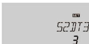
La fonction « Augmentation température du retour » sert à chauffer le retour avec la chaleur du circuit solaire.
