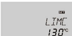
Lorsque la température du capteur dépasse la valeur limite préétablie (**LIMC / LIMC1 / LIMC2**), la pompe solaire s'arrête (R1/R2) afin d'éviter tout dommage des composants solaires par effet de surchauffe (désactivation de sécurité du capteur). Le symbole  $\Delta$  clignote sur l'écran.
