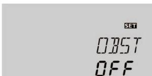
Cette fonction sert à activer une pompe supplémentaire pendant le remplissage du système. Dès que le chauffage solaire a lieu, le relais R3/R4 est mis sous tension parallèlement au relais R1. Une fois la durée de remplissage (**tREM**) écoulée, le relais R3/R4 se désactive.
