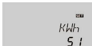
Ce canal indique la quantité de chaleur récupérée par le système lorsque l'option « Bilan calorimétrique » est activée.
