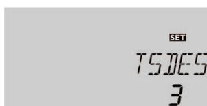
La **désinfection thermique** peut être réalisée par le biais de la sonde la mieux placée parmi celles proposées (S2, S3, S4, S5). La sonde réglée par défaut est la sonde S3.
