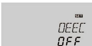
La fonction d'évacuation de l'excès de chaleur **OEEC** sert à régler le relais sélectionné sur 100% lorsque la température du capteur est égale à la valeur de surtempérature **STCP** prédéfinie et à le désactiver lorsque la température du capteur est inférieure à la valeur **STCP** de 5 K.
