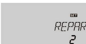
Cette fonction permet de commander un appareil doté d'un relais propre (par exemple une vanne) en même temps que la pompe (**REPAR**).
