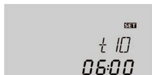
La fonction thermostat inclut 3 plages horaires (t1 ... t3) pour son fonctionnement. Les heures d'activation et de désactivation se règlent par intervalles de 15 minutes. Si vous réglez l'activation et la désactivation à la même heure, la plage horaire ne fonctionnera pas.
