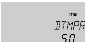
Lorsque cette fonction est activée, le réservoir continue de chauffer même lorsque la différence de température entre le réservoir et le capteur est inférieure à la valeur de désactivation préétablie. Il cesse de chauffer lorsque la différence de température entre la sonde départ et la sonde retour est inférieure à la différence de marche prolongée DT prédéfinie.
