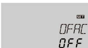
Cette fonction tient compte de la position défavorable des sondes, par exemple dans le cas de sondes placées sur un capteur à tubes sous vide.
