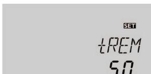
Le paramètre **tREM** permet de définir la durée de remplissage du système. Pendant cette durée, la vitesse de la pompe sera réglée à 100 %.
