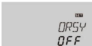
La fonction de refroidissement du système sert à maintenir l'installation solaire activée pendant une période prolongée. Elle ne tient pas compte du seuil maximal préétabli afin d'alléger la contrainte thermique à laquelle sont soumis le capteur et le caloporteur lors de journées très ensoleillées.
