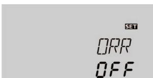
La fonction de refroidissement du réservoir permet de refroidir celui-ci pendant la nuit afin de le préparer au chauffage du lendemain.
