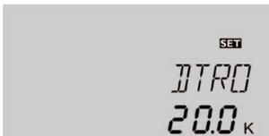
Lorsque la température du réservoir excède le seuil maximal prédéfini et que la différence de température entre le capteur et le réservoir atteint la valeur d'activation **DTRD**, l'installation solaire reste activée ou est mise en route lorsqu'elle est désactivée. Le réservoir est alors chauffé jusqu'à ce que cette différence de température soit inférieure à la valeur **DTRF** préétablie ou jusqu'à ce que la température du capteur atteigne le seuil maximal prédéfini.
