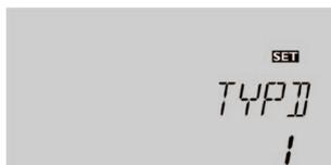
Le bilan calorimétrique peut s'effectuer de 3 manières différentes (cf plus bas) : sans débitmètre, avec un débitmètre V40 ou par le biais des sondes Grundfos.
