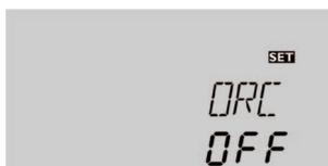
La fonction de refroidissement du capteur permet de maintenir la température et la contrainte thermique le plus bas possible au sein de l'installation.
