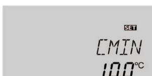
La température minimale du capteur sert à définir un seuil minimal que celui-ci doit dépasser pour que la pompe (R1/R2) puisse se mettre en marche. Elle permet d'éviter une mise en marche trop fréquente de la pompe en cas de faible température du capteur. Lorsque la température du capteur atteint ce seuil minimal, le symbole  $\star$  clignote sur l'écran.
