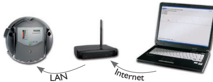
Schematische Darstellung: Zugriff auf DL2 über das Internet
