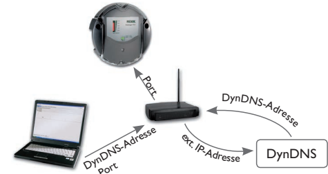
Schematische Darstellung: Fernzugriff auf den DL2, Router mit DynDNS Adresse
