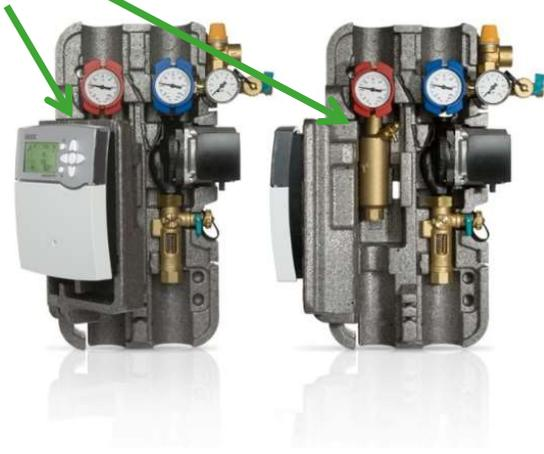
Disponen de caudalímetro de émbolo, llave de vaciado, bomba circuladora SOLAR, termómetros y antirretornos con válvula de cierre en una misma llave, manómetro, válvula de seguridad, llave de llenado, desaireador tubular y toma de 3/4" para la conexión del vaso de expansión.
